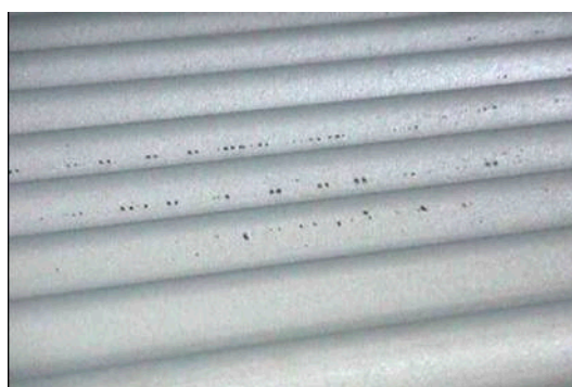
Figura 4: Ejemplos de "galling".
