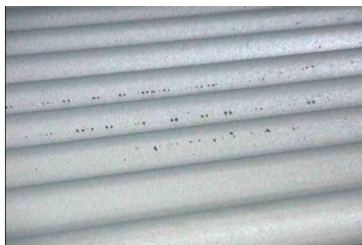
Figura 4: Ejemplos de "galling".
